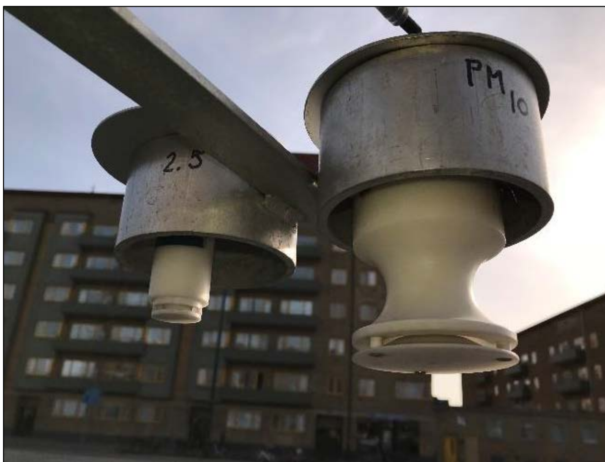
Figur 20. Filterhållarna PM 10 och PM 2,5 för mätning av tungmetaller och PAH på Dalaplan i Malmö.
