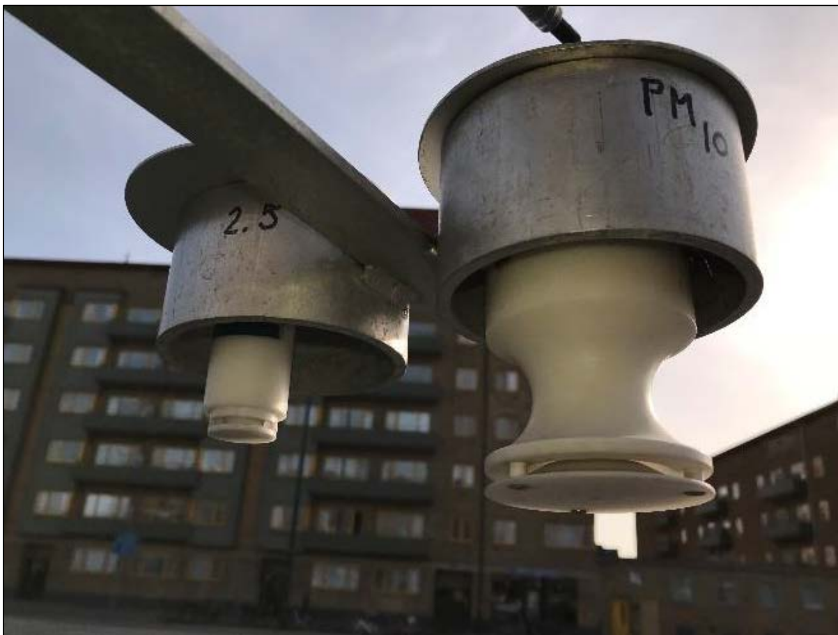
Figur 20. Filterhållarna PM 10 och PM 2,5 för mätning av tungmetaller och PAH på Dalaplan i Malmö.
